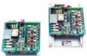
Der erste Frequenzumrichter zur Steuerung von Drehstrommotoren kommt auf den Markt.
